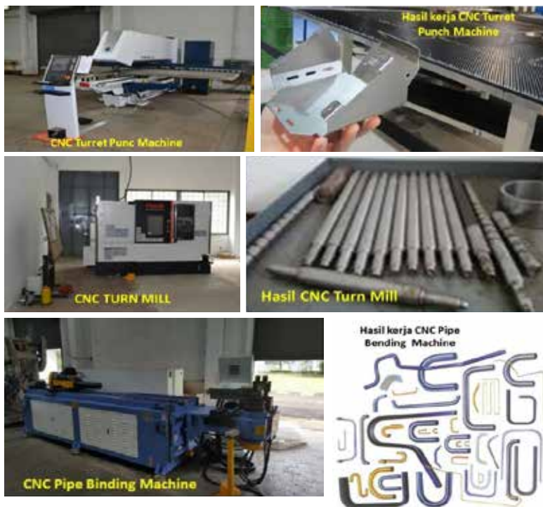
Gambar 34. CNC Turret Punch dan CNC Pipe Binder
