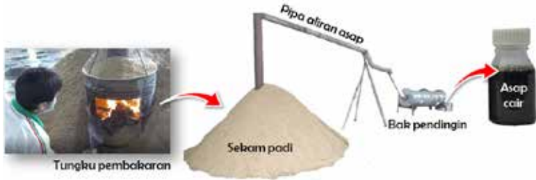
Gambar 82. Proses produksi asap cair dari sekam padi secara sederhana
