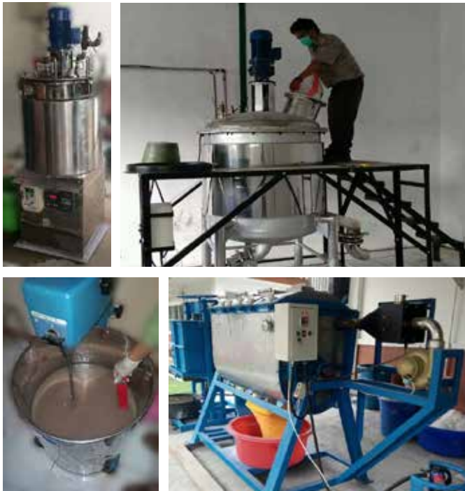
Gambar 84. Beberapa alat utama untuk proses produksi biosilika dari sekam padi (Hoerudin et al. 2017)
