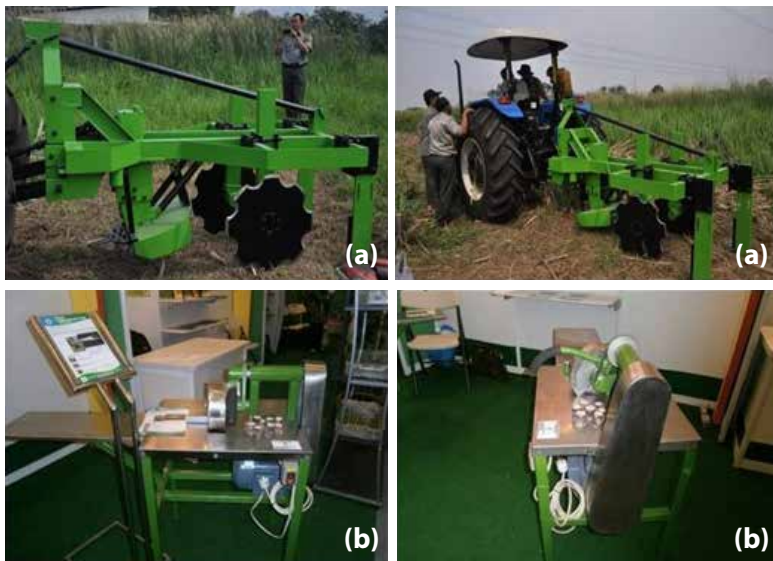
Gambar 10. Teknologi mekanisasi untuk tanaman perkebunan, yaitu (a) Mesin rawat ratoon tebu; dan (b) Mesin pembibitan tebu/ butt chip
