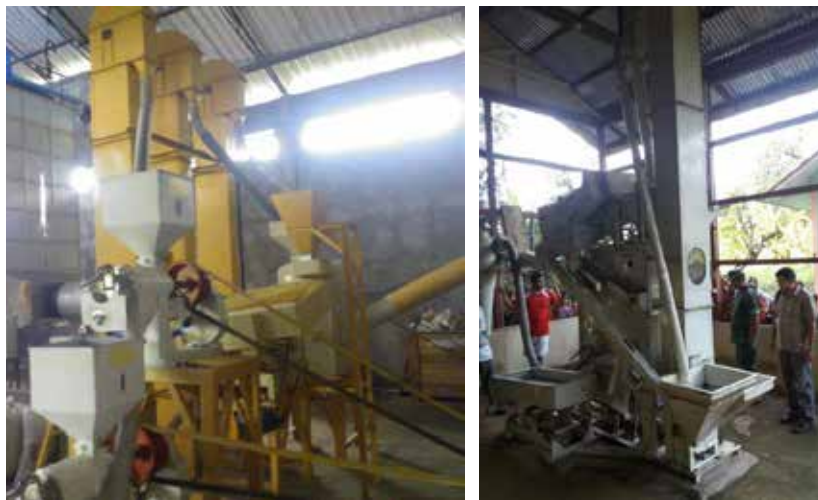
Gambar 71. Mesin penggilingan padi yang dilengkapi dengan separator
