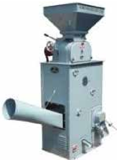
Gambar 72. Mesin pengupas kulit gabah (pecah kulit) tipe rol karet
