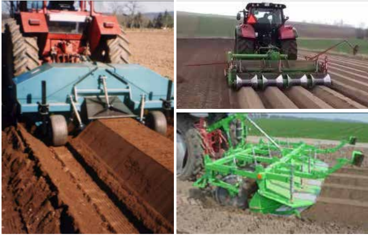
Gambar 53. Penggulud digandengkan langsung dengan rotary atau piringan
