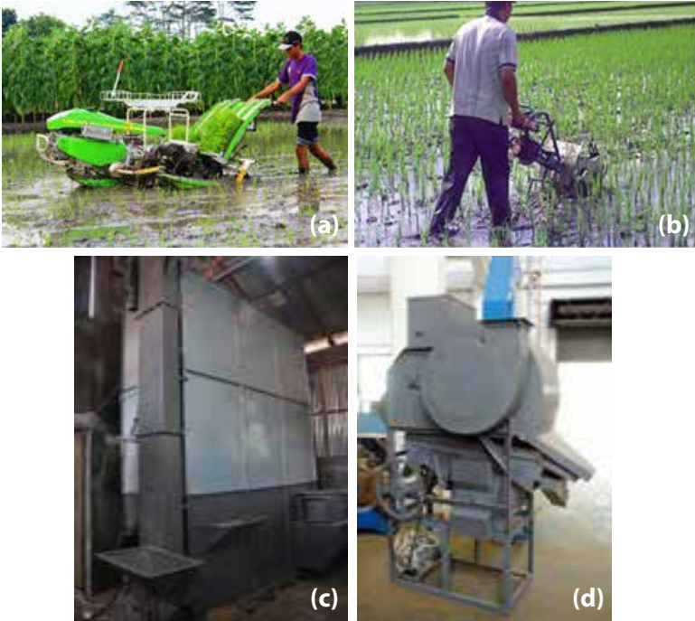
Gambar 9. Jenis-jenis alsintan, yaitu (a) Mesin transplanter jajar legowo; (b) Mesin power weeder (penyiang); (c) Mesin pengering; dan (d) Mesin pembersih ( paddy cleaner )
