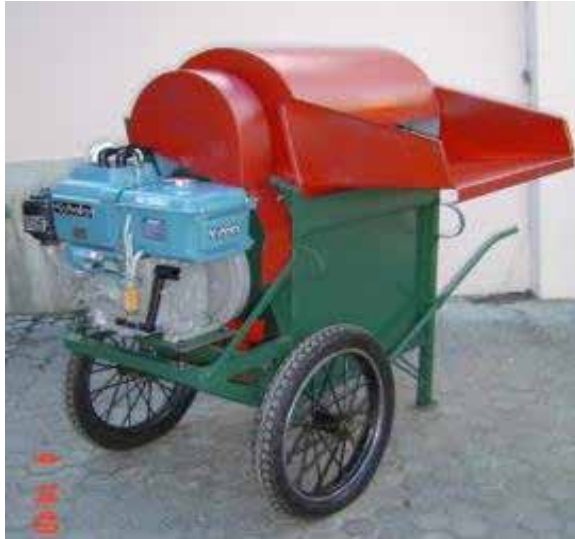
Gambar 65. Mesin perontok padi tipe throw-in dengan penggerak motor diesel.
