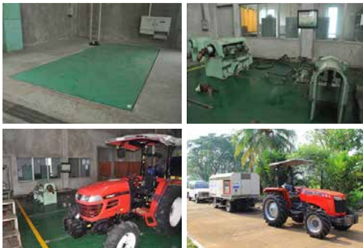
Gambar 37. Test rig untuk uji power pada poros traktor roda 2 dan uji konsumsi bahan bakar
