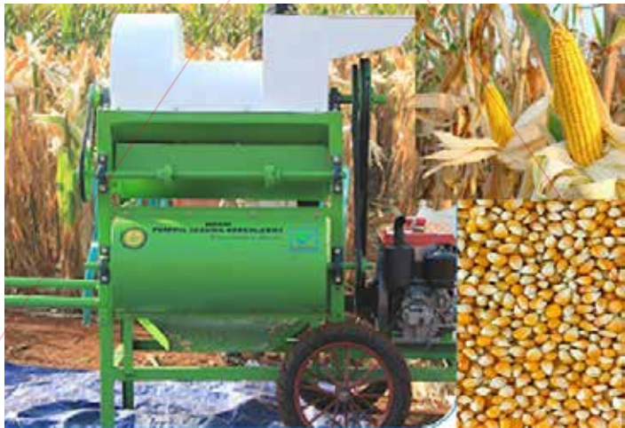
Gambar 40. Mesin pemipil jagung berkelobot.
