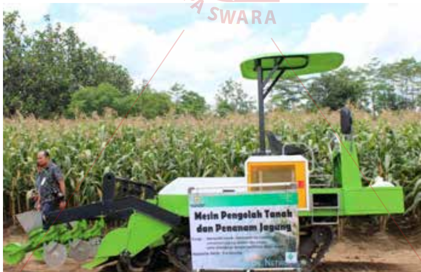
Gambar 37. Mesin rota-tanam jagung.
